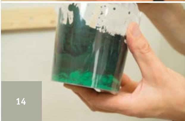
4. Mit einem Rührholz o. ä. Pigmente am Becherboden mit-einrühren, bis sie zu einer homogenen Masse werden.
