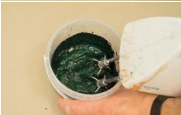
3. Pigmente mit einem Handrührgerät oder einem Rührholz klümpchenfrei vermengen, bis die Pigmentmischung zähflüssig ist.
